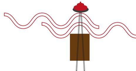
Se debe colocar amarres metálicos, que tengan capuchón para evitar la filtración del agua. preferiblemente realizando la apertura con taladro para la instalación de los mismos.
