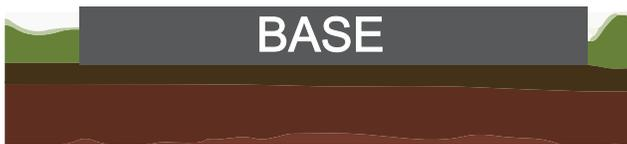
Según las condiciones del suelo haga una base que soporte el peso del tanque lleno de agua. La superficie debe quedar plana, firme, continua y nivelada.
