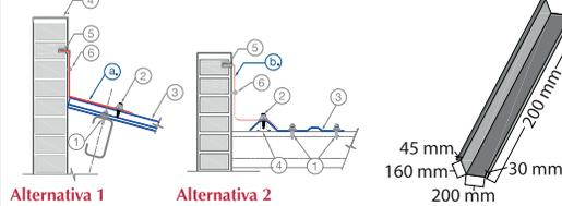
1. Fijar en el valle de la teja con Tornillo Auto perforante Ajoover
